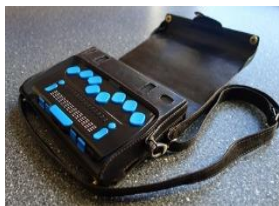
Портативный компьютер с вводом/выводом шрифтом Брайля и синтезатором речи «EIBraille- W14J G1
