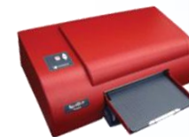
Брайлевский принтер тактильной графики с возможностью цветной печати ViewPlusEmprintSpotDot
