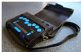
Портативный компьютер с вводом/выводом шрифтом Брайля и синтезатором речи «ElBraille- W14J G1»
